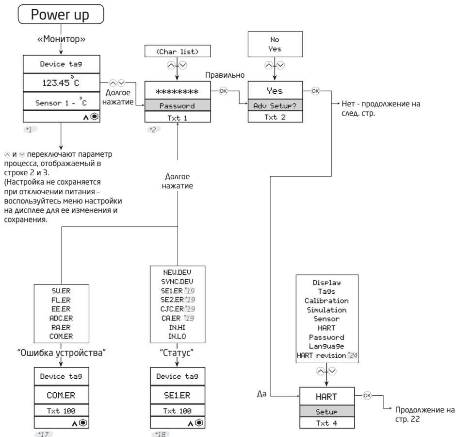
\*1 Если в течение 60 с не производилось нажатия кнопок (для меню Sim (Имитация) и Cal (Калибровка) в теч. 10 мин), сохранения не производится и дисплей возвращается в режим мониторинга.
