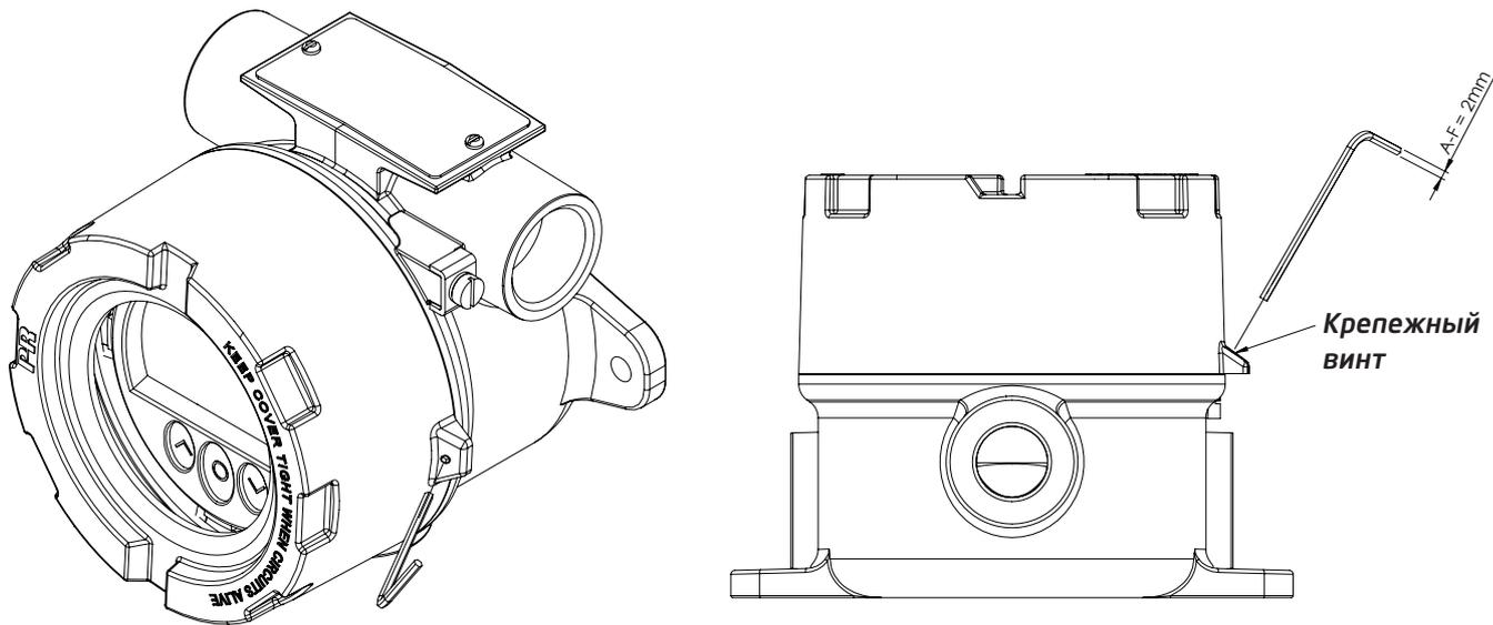
1. Ослабьте **крепежный винт** с помощью ключа-шестигранника с крестообразным шлицем 2 мм. Этот винт находится на верху корпуса.
