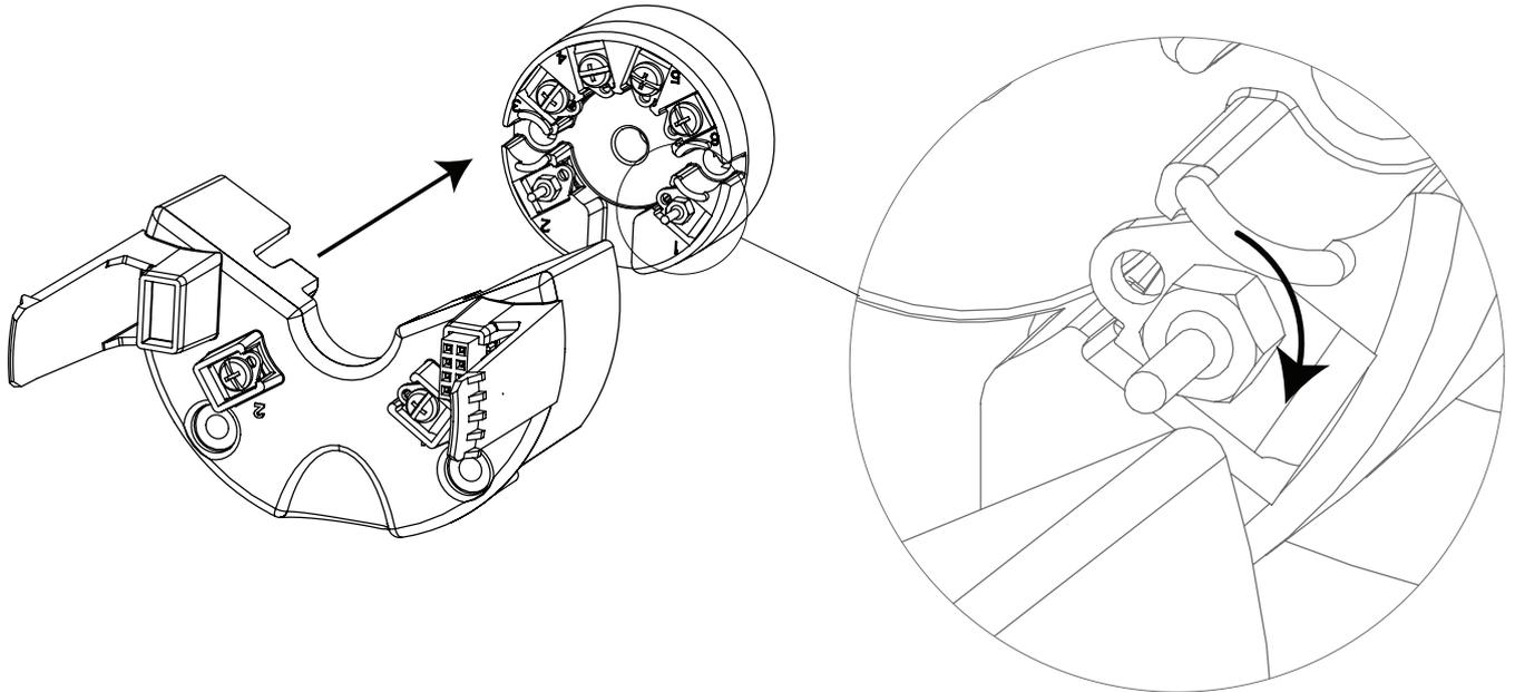
1. На модуле 5335 / 5337 удалите винты клемм 1 и 2 с помощью отвертки.
