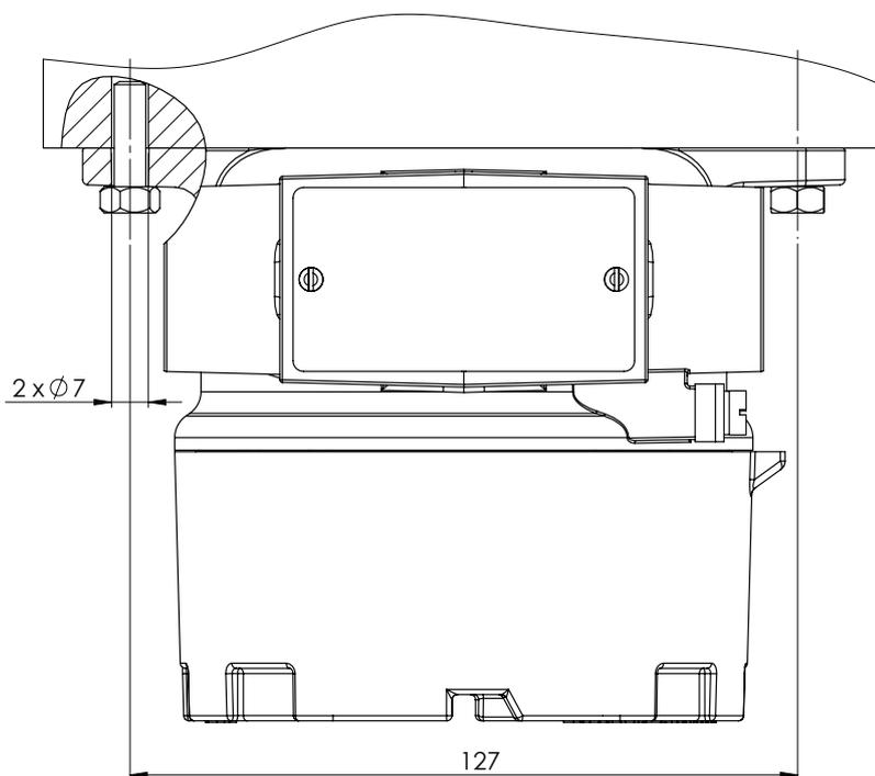
Установка на трубопровод - вид спереди и сбоку
